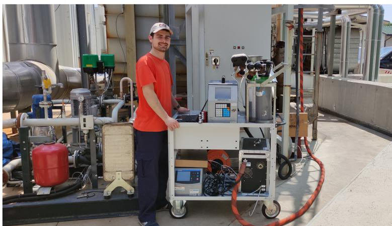
Attrezzatura per campionamento parametri della combustione in emissione
