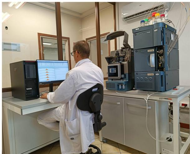
Sistema di cromatografia liquida per analisi PFAS
